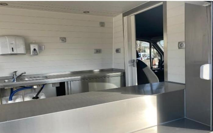
Auch eine neue Rückwand zur Fahrerkabine mit klappbarer Falttür, ein rutschfester Fußbodenbelag und die Elektroinstallation mit Lichtanlage sind im Grundpreis enthalten. Ein Wechselrichter mit Solarbatterie sorgt für die interne Stromversorgung für z.B. Kaffeemaschine, Sahnemaschine, Mixer und Kuchenvitrine und kann gegen Aufpreis eingebaut werden. Dies ist aber für die Kühltechnik nicht notwendig. **Preis: 29.900,- Euro**
